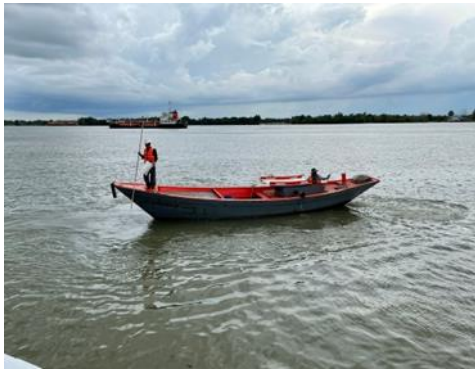
รูปที่ 2-1 เรือเล็กขนาดเครื่องยนต์ 24 แรงม้าใช้ในการลากบูม
